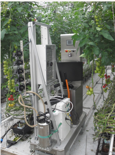
Side Crop Viewer mit Chlorophyll-Fluoreszenz-Sensor und Spritzbaum.
